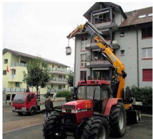
Das Herunterheben der Blumentröge verlangte vom Kranchauffeur einiges ab, war es doch oft eine Millimeterarbeit. Zudem wog ein Behälter ca. 250 Kilogramm.
